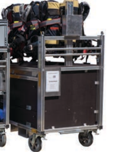
Container Nr. 18 Atemschutz Preßluftatmer, Atemschutzmasken, Atemluftfilter, Brandfluchthauben, Wechselkleidung u.v.m.
