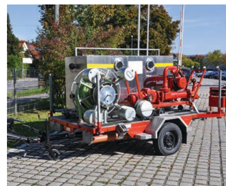
Öl-Sanimat: Fahrbarer Ölabscheider zum Trennen von Wasser von Öl, Diesel und Benzin oder anderer schwimmfähiger Chemikalien.
