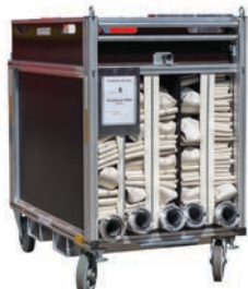
Container Nr. 8 - 10 B-Schlauch, gebuchtet B-Schlauch 500 m, Schlauchbrücken, Schlauchbinden u.v.m.
