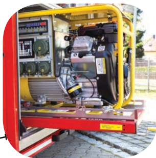
Stromerzeuger 3 kVA zum Betreiben von elektrischen Rettungsgeräten am Einsatzort
