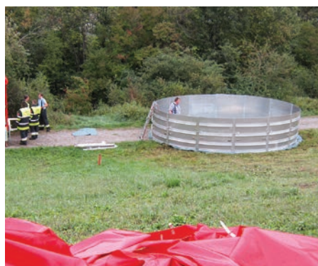
Ölauffangbecken für 52.000 Liter Öl-Wasser-Gemisch, das vom verschmutzten Gewässer abgepumpt wurde.
