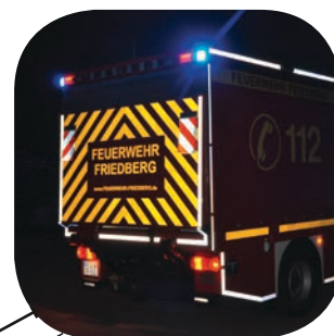
Ladebordwand 2 t Hubkraft reflektierend beklebt
