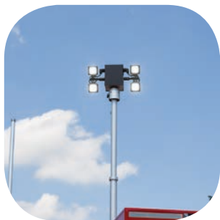
Lichtmast LED-Lampenbrücke zum Ausleuchten der Einsatzstelle
