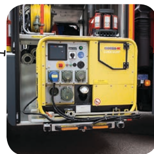
Stromerzeuger zum Betrieb der elektrischen Geräte am Einsatzort
