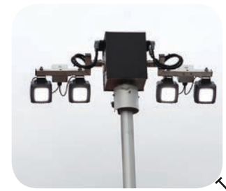
Fahrzeuglichtmast mit 4 x 40 Watt LED-Scheinwerfer zum Ausleuchten der Einsatzstelle
