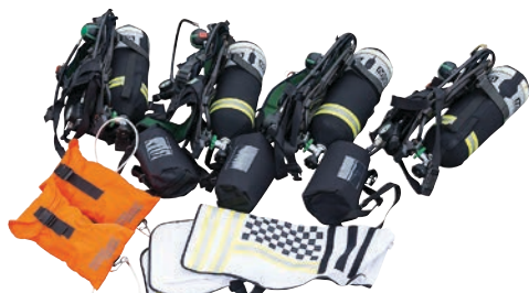
Atemschutz-Ausrüstung Atemluftflaschen, Atemschutzmasken, Sicherungsleinen, Atemschutzüber- wachungsweste u. -tafel für den Löscheinsatz und zur Personenrettung in verrauchten Gebäuden
