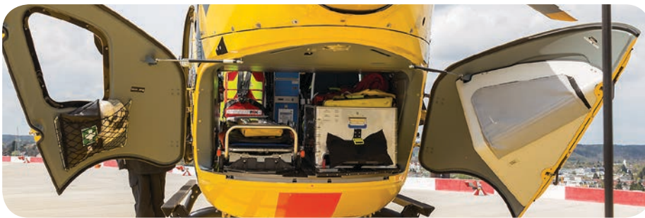
Hecktüren mit Patientenbereich links und medizinischer Beladung rechts. Weitere Staufächer mit Notfallversorgung in den Türen.
