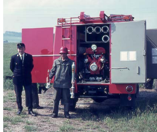
Löschgruppenfahrzeug (LFB) mit Tragkraftspritze. Der Maschinist hält ein C-Strahlrohr sowie ein Schaumrohr in den Händen.
