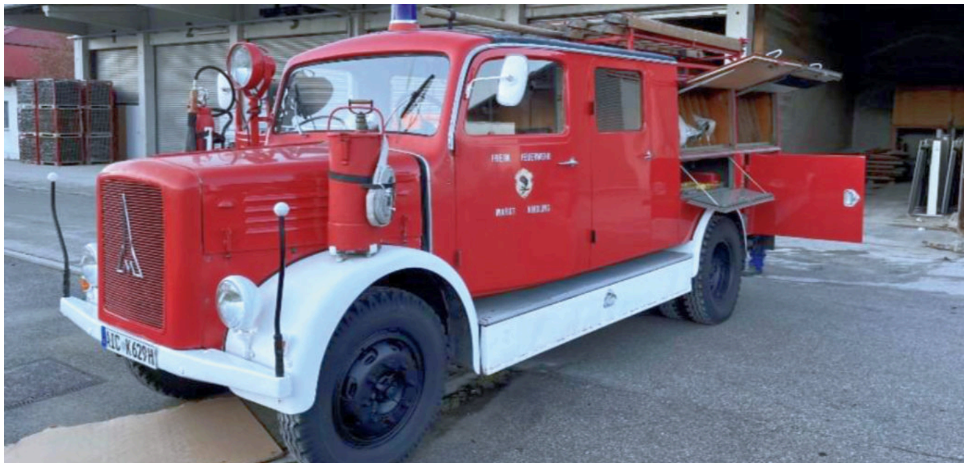
KHD Fliiegerkraftfahrerspritze FKs15, Baujahr 1942, war bis 1945 Löschfahrzeug der Luftwaffe und von 1948 bis 1992 im täglichen Einsatz der Freiwilligen Feuerwehr Markt Aindling. Besonderheit: Neben dem damals schon vorhandenen 500l Löschwassertank, hat dieses Löschfahrzeug einen Aufbau aus Holz.
